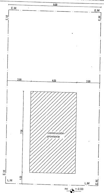
El cerramiento vertical que se encuentre una distancia menor a 2.00m del eje medianero deberá recubierto con revestimiento material ignífugo, previamente se deberá pintar su estructura de madera con pintura ignifuga.
