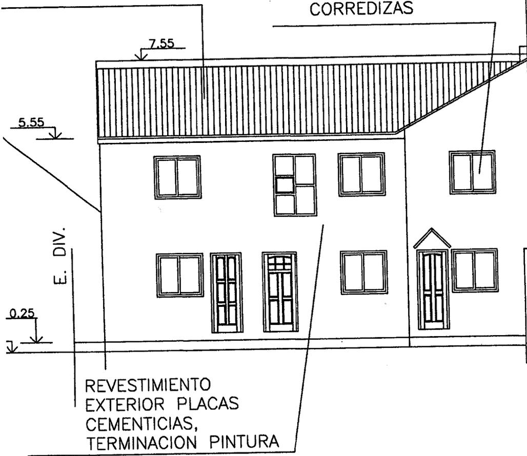
ESTRUCTURA METÁLICA, CERRAMIENTO DE PARED SOBRE EJE DIVISORIO DE BLOQUES DE HORMIGÓN, TERMINACIÓN REVESTIMIENTO EXTERIOR REVOQUE FINO A LA CAL
